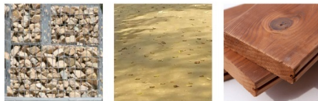
Mur de gabions amb pedra reciclada Establització de terra existent Fusta per conformar bancs
